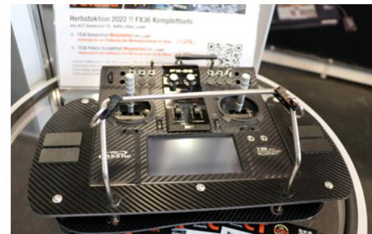
Knüppelfunktion verfügt über eine digitale Trimmung, die FX36 hat außerdem einen S.BUS- und Kopfhöreranschluss sowie eine Trainer-/DSC-Buchse.
