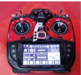
Mit im Gepäck hatten sie unter anderem die neue **Graupner mz-32**, ein 32-Kanal-Sender mit großem Farb-TFT-Bildschirm, einem redundanten Doppel-2,4-GHz-System, integriertem 9.000-mAh-LiPo, Unterstützung aller Modell-Typen, zwölf Flugphasen, 16 Kurvenmischern und einem Speicher für bis zu 999 Modelle.
