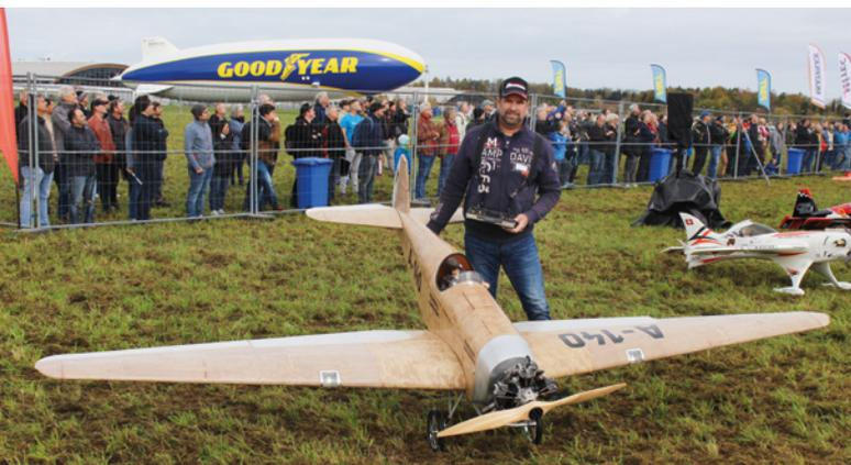
Als Gewinner des FMT-Adlers in der Eigenbau-Kategorie brachte Markus Frey seinen Eigenbau der Messerschmitt M 23c mit nach Friedrichshafen. Das Modell ist eine komplette Holzkonstruktion mit einer Spannweite von vier Meter und 20 kg Gewicht, angetrieben von einem 250er Moki.
