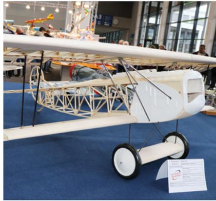
gen Holzteilen, Kleinteilen, Anlenkungen und einer bebilderten Anleitung. Technische Daten: Spannweite 2.844 mm, Länge 1.246 mm, Gewicht ca. 2.100 g. Kostenpunkt: 389,- € (UVP).
