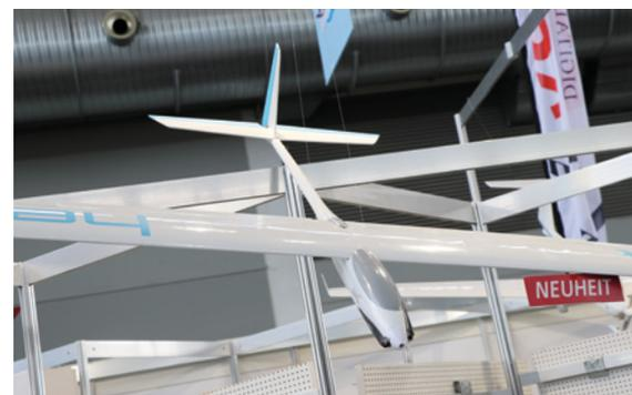
Seit dem Sommer gibt es den 6-Klappen-Segler **Helixx**, der sich als Segler oder Elektrosegler aufbauen lässt. Der Bausatz enthält alle benötigten, lasergeschnittenen Holzteile, den weißen GFK-Rumpf mit Kabinenhaube, Anlenkungs- und Kleinteile, 3D-Bauanleitung, Bauhelling. Technische Daten: Spannweite 2.840 mm, Länge 1.300 mm, Gewicht ab 1.880 g. UVP: 269,- €.
