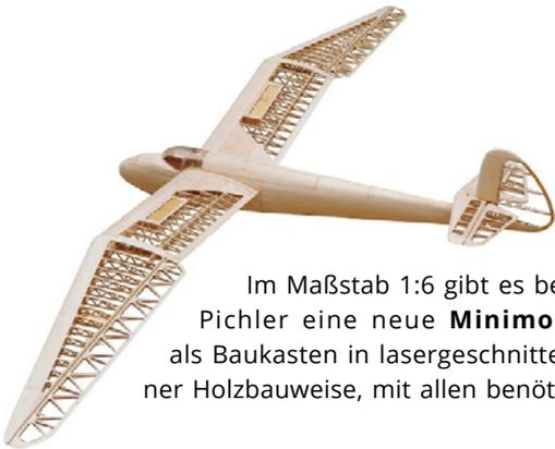
Im Maßstab 1:6 gibt es bei Pichler eine neue **Minimoo** als Baukasten in lasergeschnittener Holzbauweise, mit allen benötigten
