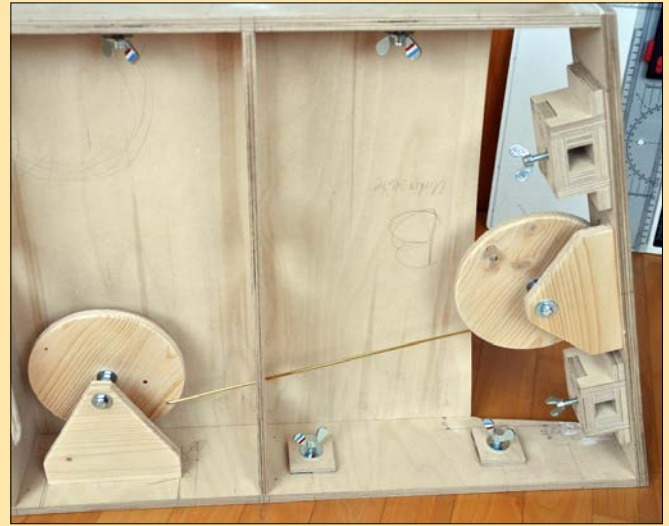
Noch vor allem anderen wurde die Antriebstechnik für die Drehscheibe eingebaut. Das Handrad (rechts) ist über eine Stellstange mit der Holzscheibe unter der Grube verbunden.
