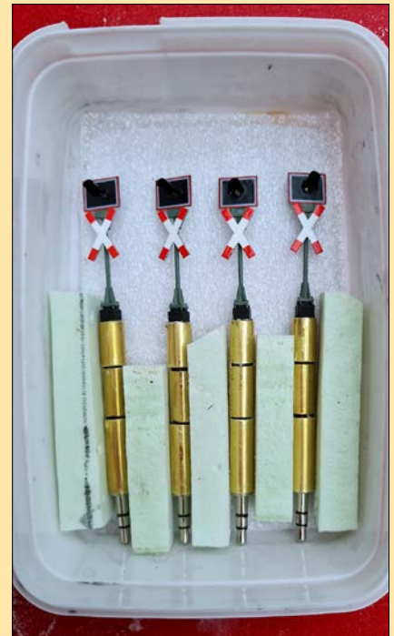
Nach dem Bau von vier Andreaskreuzen hat man den Bogen raus. Sie sind nun fertig zum Einstecken ins Modul und Anschließen an die Elektronik mittels Klinkensteckern. Eine Dose dient als sichere Verpackung.
