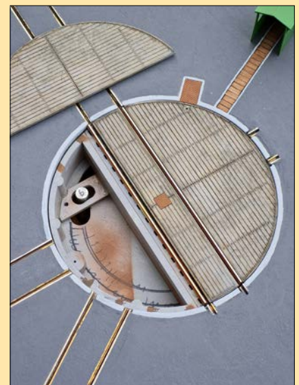
Polystyrolstreifen helfen ebenfalls dabei, die Spurkranzrillen zwischen Schienen und Abdeckung zu verschmälern bzw. auf der Außenseite zu schließen.
